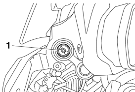
1. Tomada auxiliar DC
